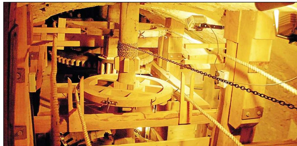
**Der neu installierte Mahlgang** in der Ennigerloher Windmühle markiert das Ende der Sanierung der Technik im Inneren.
