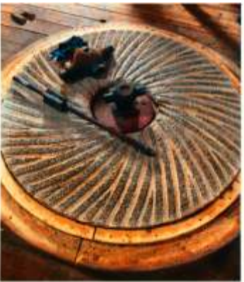
Mahlsteine müssen von Zeit zu Zeit ausgebaut und geschärft werden
