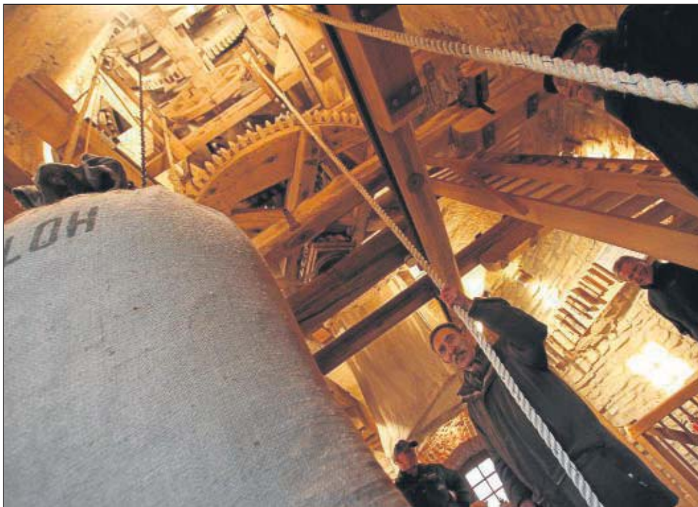
Fritz Meyke bedient den Binnendreher, der die Haube und somit die Flügel der Mühle in den Wind dreht. Das Räderwerk ist komplett aus Holz.
